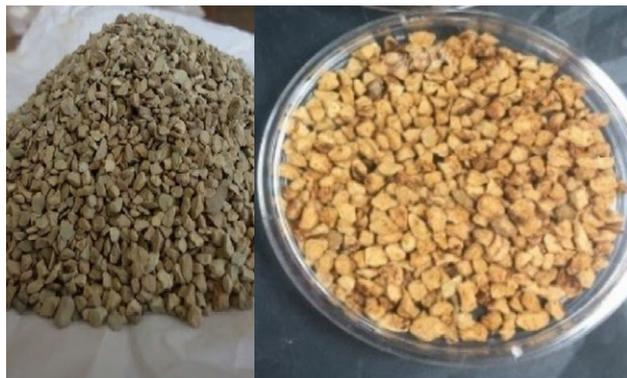
Figura 2. Zeolita natural (izquierda) y zeolita modificada para la remoción de fluoruros de agua (derecha).
